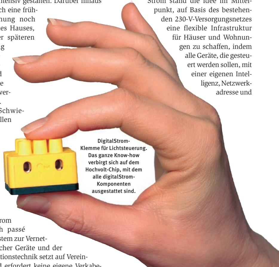
**DigitalStrom-Klemme für Lichtsteuerung.** Das ganze Know-how verbirgt sich auf dem Hochvolt-Chip, mit dem alle digitalStrom-Komponenten ausgestattet sind.
